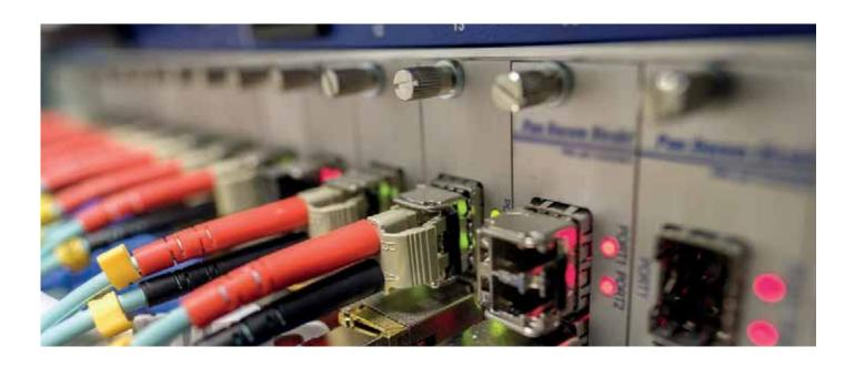
In der Nachrichten- und Datentechnik ist die Signalübertragung über Glasfaser- Lichtwellenleitungen längst Stand der Technik. Die gravierenden Vorteile wie: EMV-Unempfindlichkeit, hohe Übertragungsbandbreite und geringes Gewicht lassen sich auch in der MSR-Technik sinnvoll nutzen. Im Maschinenbau stellt sich oft das Problem, (Mess-)Daten einer Maschine störungsfrei zu übertragen. Elektromagnetische Störfelder von Aggregaten und oft nicht beeinflussbare Leitungswege können hierbei störend wirken.
